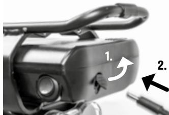
3. Verbinden Sie das Ladegerät mit dem Akku (Sekundärstecker)(2.), anschließend den Stecker mit der Steckdose (Primärstecker).
