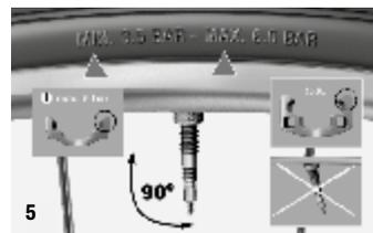
• Zentrieren Sie den Reifen, bevor Sie ihn bis zum gewünschten Druck aufpumpen. Der zulässige Druckbereich ist auf der Reifenflanke angegeben (Abb. 5). Der vorgegebene Luftdruck muss dringend eingehalten werden, da zu niedriger Luftdruck durch walken den Reifen und Schlauch zerstört. Ebenso zu hoher Luftdruck bei extremer Belastung, z.B. Bordsteinkante zum Platzen des Schlauches und somit zum Sturz führen kann.
