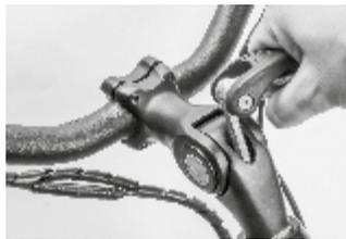
☞ Lösen Sie die Vorbauspindel, um den Lenkervorbau in der Höhe zu verstellen. Achten Sie hierbei auf die Markierung am Vorbauschaft. Diese darf keinesfalls überschritten werden.
