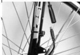
kappen auf der Motorachse und lösen Sie die Achsmuttern mit einem Gabelschlüssel.
