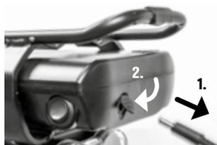
Verschließen Sie die Ladebuchse mit der dafür vorgesehenen Abdeckung (2.), um Wassereintritt und Korrosion zu vermeiden.
